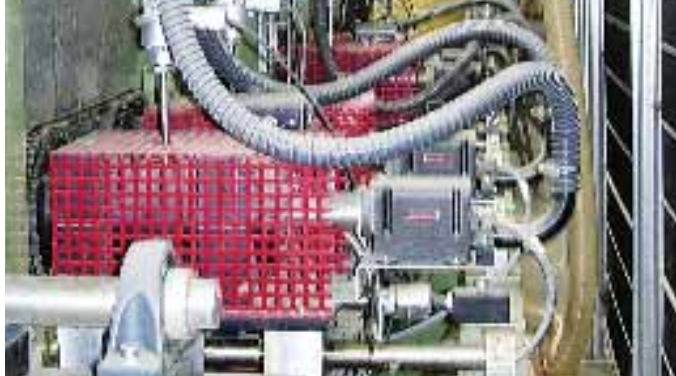
LHS-Lufterhitzer in einer Produktionslinie für Wärmedämmung.
