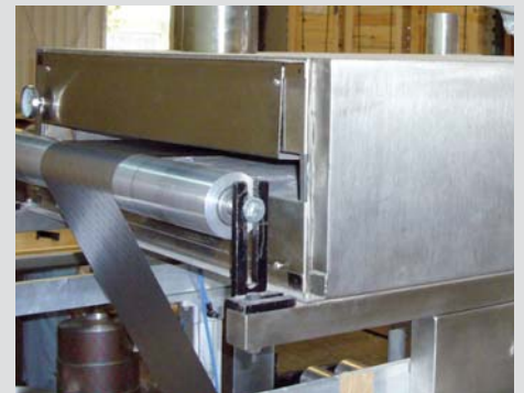
Trocknungstunnel mit integriertem AIR RADIATION HEATER.
