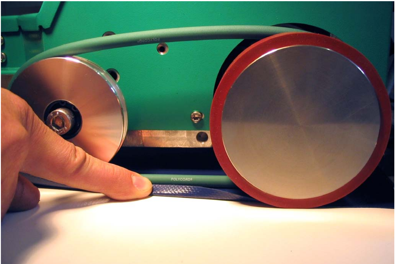
Oberliegende Folienkante zum leichteren Einführen der Schweissdüse anheben
